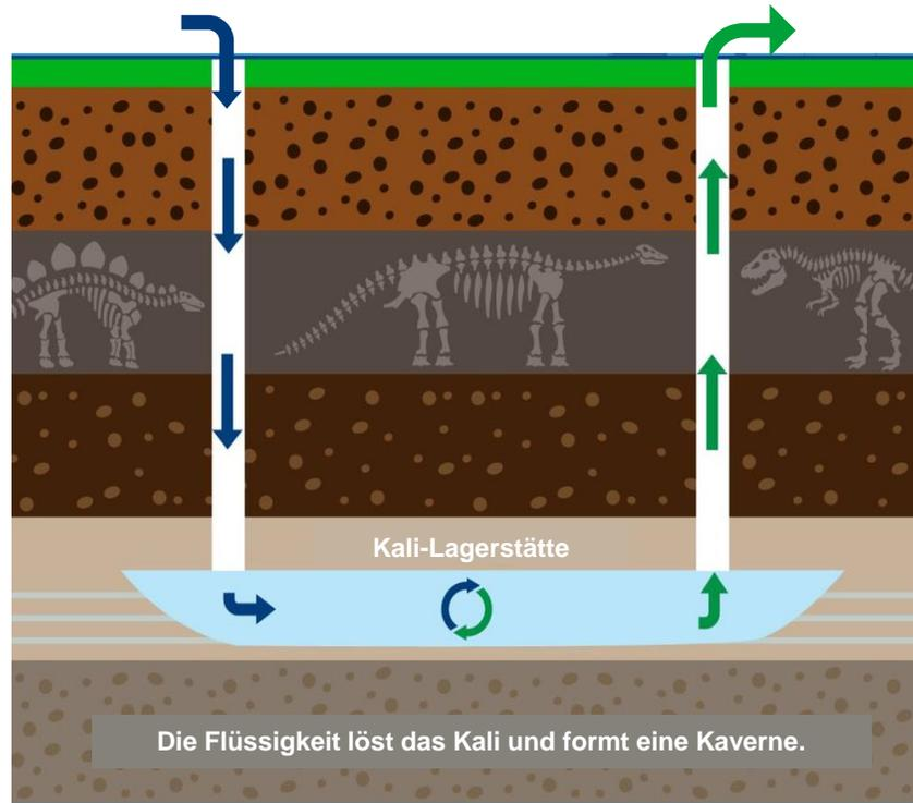
Beim **Primary Mining** wird Frischwasser in die KCl-haltige Schicht gepumpt, wodurch sogenannte Kavernen entstehen.
