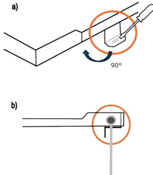
7. Die beiden Sicherungsglaschen an dem Rahmen mit einem Schraubenzieher um 90° umbiegen (a), sodass diese an der oberen Gitterstange des Gestells fixiert sind (b).
