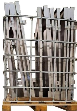
**Abb. 1:** Transportiert werden die Rahmen hochkant in einem leeren Gittergestell.
