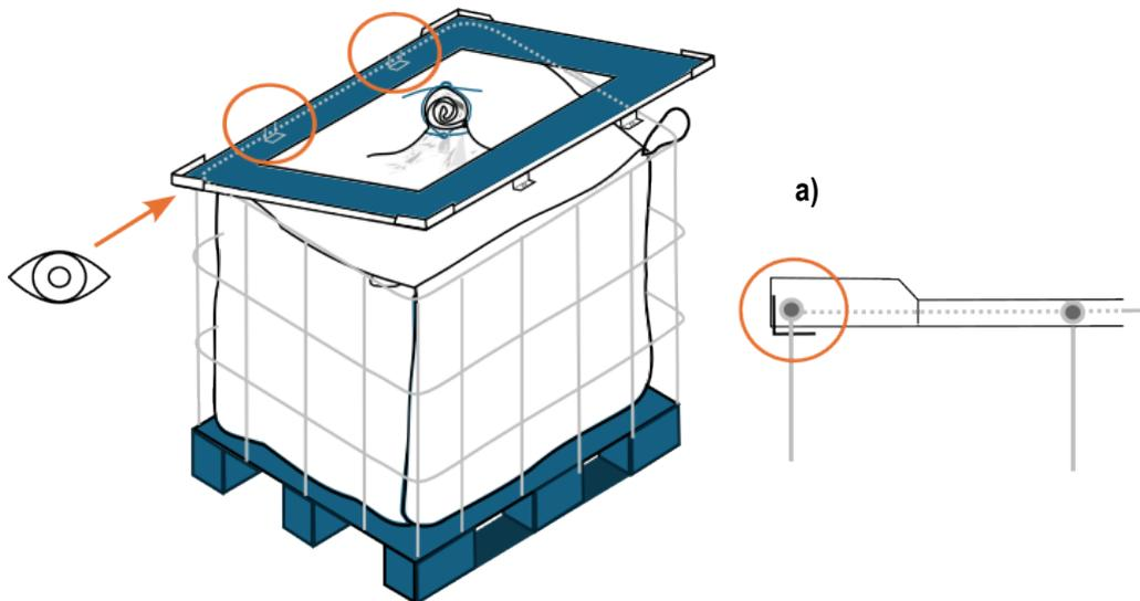
6. Den Rahmen auf das Gittergestell auflegen und die nach innen gebogenen Sicherungshaken mit der obersten horizontalen Gitterstange des Gestells positionieren (a).
