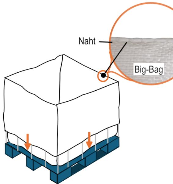
**2.** Schürze über das Gittergestell nach außen stülpen und an der Außenseite des Gestells herunterziehen, bis die Naht zwischen Big Bag und Schürze mit dem oberen Rand des Gittergestells abschließt.
